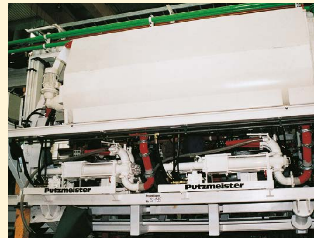
Platzsparender Einbau von zwei KOV 550 DUO unter einem 6 m³ Agitiertrog
