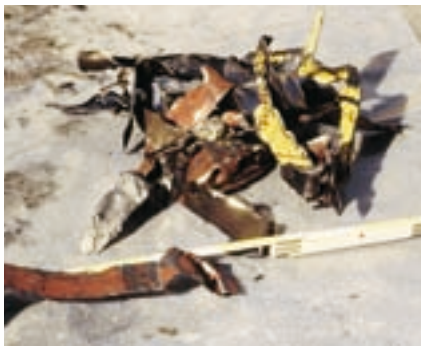
Geschredderter Fassmüll wird mit Schlamm gepumpt
